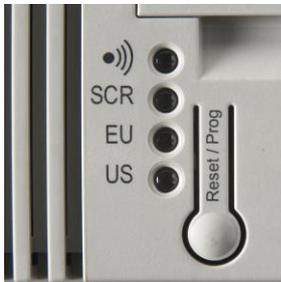
Die „US“-LED blinkt gleichmäßig, wenn die Spannung (24 V) und die KNX Busspannung aktiv am Gerät anliegen. Das Gerät ist betriebsbereit, wenn die „US“-LED blinkt.
