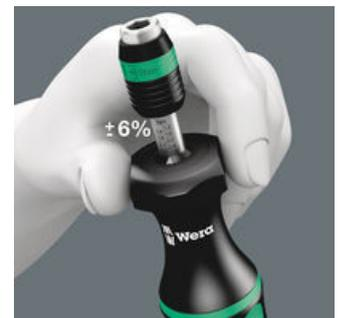
Messgenauigkeit ± 6 % (Artikel 1430: ± 10 %) nach Norm DIN EN ISO 6789. Deutlich hör- und spürbares Übrastern beim Erreichen des eingestellten Drehmoments.
