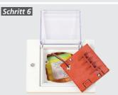
► Batteriepack an Taster anschließen.
