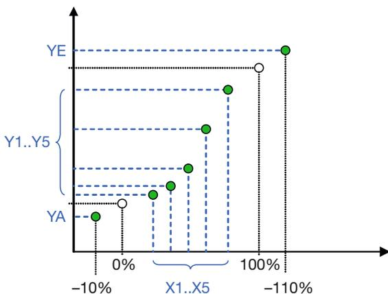
Die in den Registern OUTSET1 bzw. OUTSET2 gespeicherten Übertragungsfunktionen sind Informationen für die PC-Software, um die gewünschte Übertragungsfunktion mit den Tabellenwerten zu generieren. Für das Gerät ist diese Information bedeutungslos.
