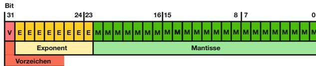
Das erste Register beinhaltet die Bits 15 – 0 der 32 Bit Zahl (Bit 0...15 der Mantisse).
