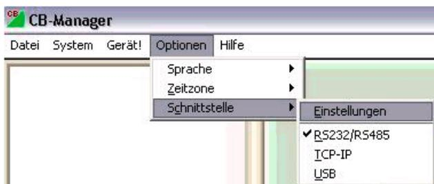
Unter Optionen / Schnittstelle ist die RS 232/ RS485 Schnittstelle auszuwählen. Dies gilt auch, wenn ein RS485/USB Konverter verwendet wird und der Konverter über den USB Anschluss mit dem Computer verbunden ist.
