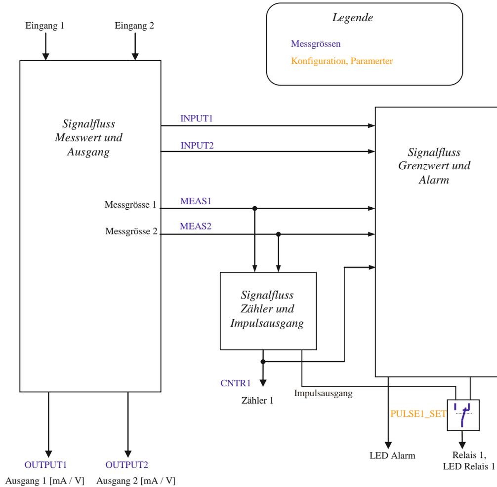
Flux du signal valeur de mesure et sortie
