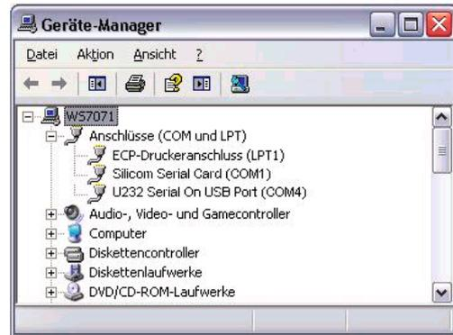
In diesem Beispiel sind die COM Ports einer PCMCIA-Karte und eines USB-RS232 Konverter dargestellt:
