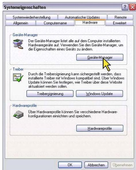
Der COM-Port eines externen RS232- oder RS485-Konverters kann über die Systemsteuerung von Windows ermittelt (und falls notwendig geändert) werden. Beispiel für Windows XP: **Systemsteuerung => System**
