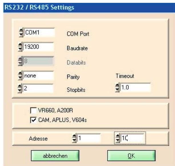
Die vorhandenen COM Ports werden während des Programmstarts und beim Wählen von RS232/RS485 als Kommunikations-Schnittstelle ermittelt. Es werden nur die gefundenen COM Ports zur Auswahl bereitgestellt.
