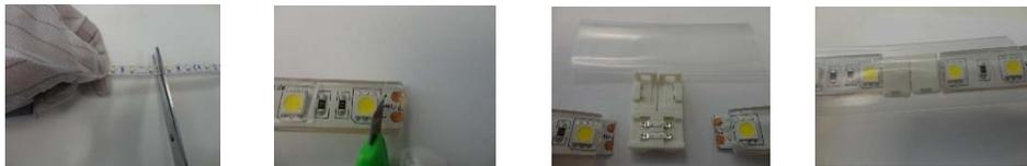
4. Nach dem Kürzen des LED Bands müssen neue Anschlusskabel aufgelötet werden (max. 270°C/ 3Sekunden) oder Anschlusskabel (Zubehör) aufgesteckt. Trennen nur an den gekennzeichneten Schnittstellen möglich. Die Vergussmasse mit einem scharfen Messer entfernt werden, um die Anschlusskontakte freizulegen. Das Platinengrundmaterial darf dabei nicht beschädigt werden. Verschließen Sie das Ende des LED- Streifens wasserfest, mithilfe einer Endkappe und des Silikons.
