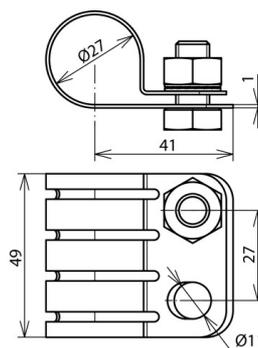
PA-Anschlusselement zum Absteuern des elektrischen Feldes der HVI power Leitung (vorkonfektioniert / Trommelware) im Bereich des Endverschlusses.
