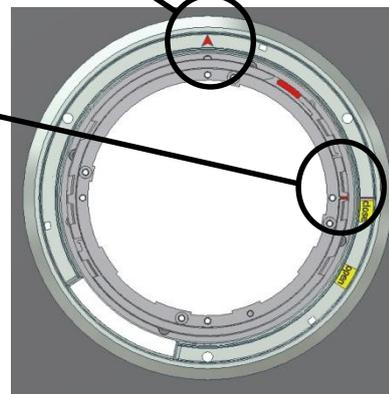
Deckelführung in Modulare Einbaudose einsetzen und mit den beigelegten Innensechskantschrauben befestigen (4x). Durch die Montagemarkierung kann die Deckelführung ausgerichtet werden. Sechskantschlüssel Nr. 3 verwenden, max. 8Nm.
