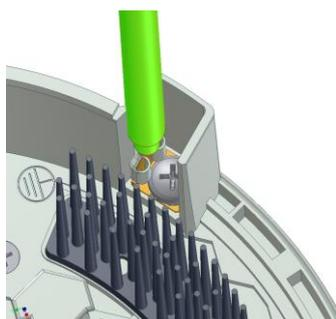
Erdungsleitung an dem Liftdeckel befestigen.
