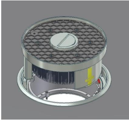
Für ungenutzten Zustand Deckel mit der gelben Pfeilmarkierung in die „Close“ Position einführen. Der Deckel versinkt komplett in der Modularen Einbaudose. Zum Verriegeln an der Lasche nach links drehen.
