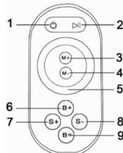
Wird die Fernbedienung länger als 20 Sekunden nicht verwendet, schaltet sie automatisch in den Standby-Modus. Durch leichtes Rütteln ist die Fernbedienung wieder einsatzbereit.
