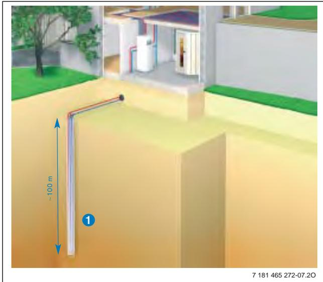
Bild 17 Erdwärmesonden
