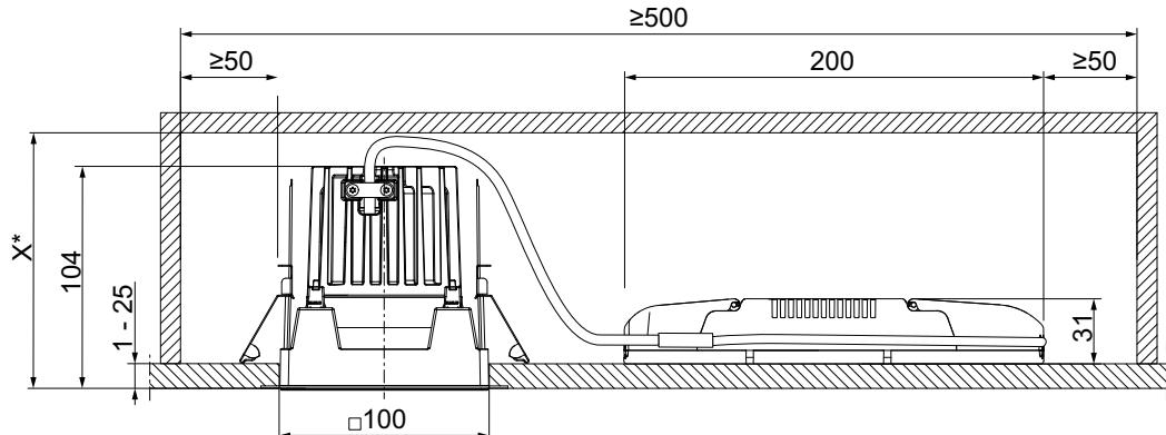
**DE** Leuchte darf nicht mit Wärmedämmung abgedeckt werden.
