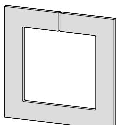
**DE** Bei dünnem oder weichem Deckenmaterial empfiehlt sich die Verwendung des Deckenverstärkungsringes zur Vergrößerung der Auflagefläche!
