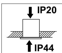
**FR** L'installation dans un plafond fermé est nécessaire pour qu'une réalisation soit IP 44. La protection IP 44 ne joue que par rapport à la pièce.
