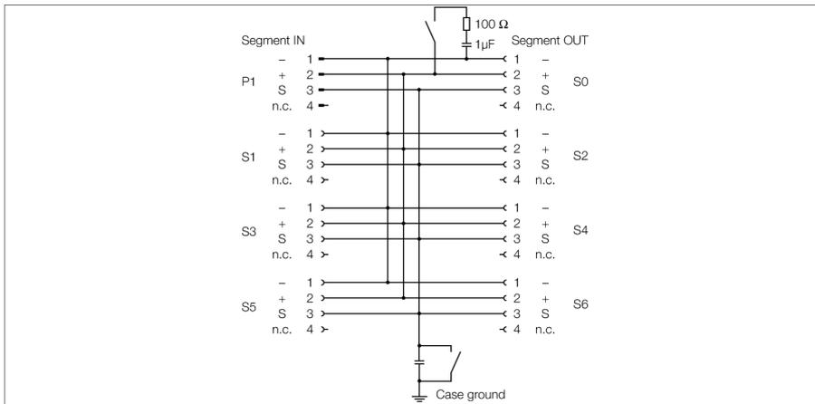
Der sechskanalige Ex-Verteilerbaustein vom Typ JBBS-49-M613/EX ist für den FOUNDATION™ fieldbus ausgelegt.
