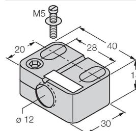
Befestigungsschelle für Gewinderohrsensoren, mit Festanschlag; Werkstoff: PA6
