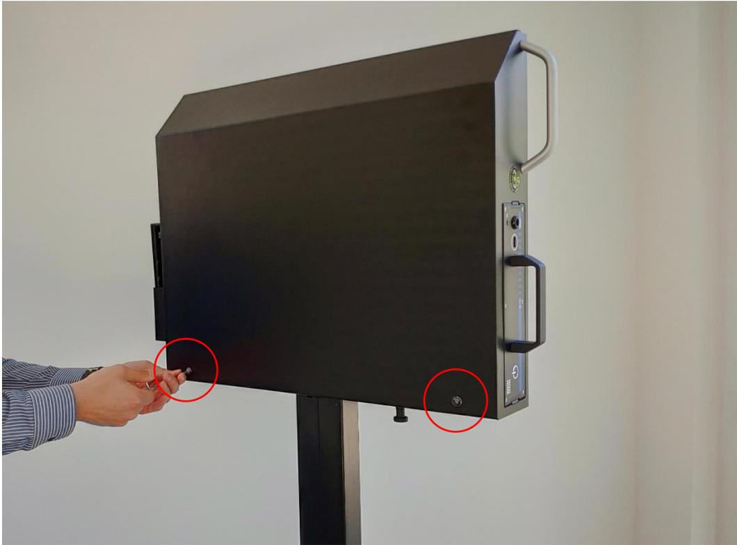
**Schritt 4: Die Abdeckung von der Monitorbox abnehmen und beiseitestellen.**
