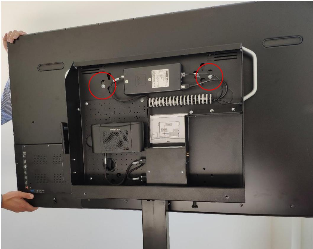
**Schritt 7: Beide Schrauben im oberen Bereich der Monitorbox festziehen.**
