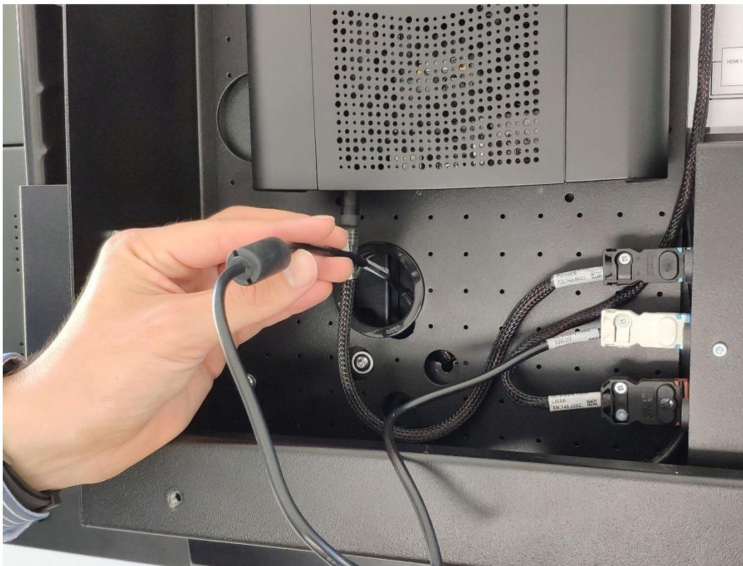
**Schritt 11: DC-Anschlusskabel an Monitor einstecken.**
