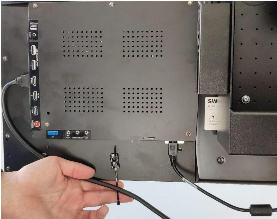
**Schritt 14: Kabel sortieren und Kabelbinder abschneiden.**
