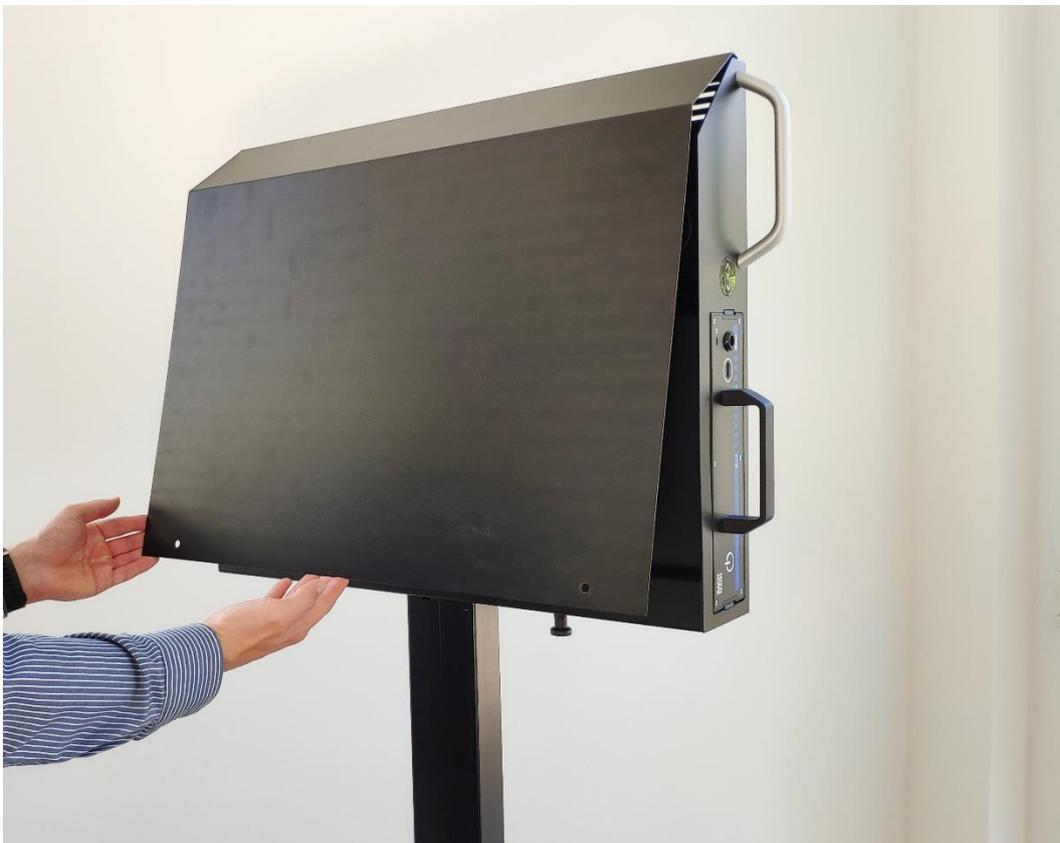
**Schritt 5: Rasthebel ziehen und Batterie entfernen.**
