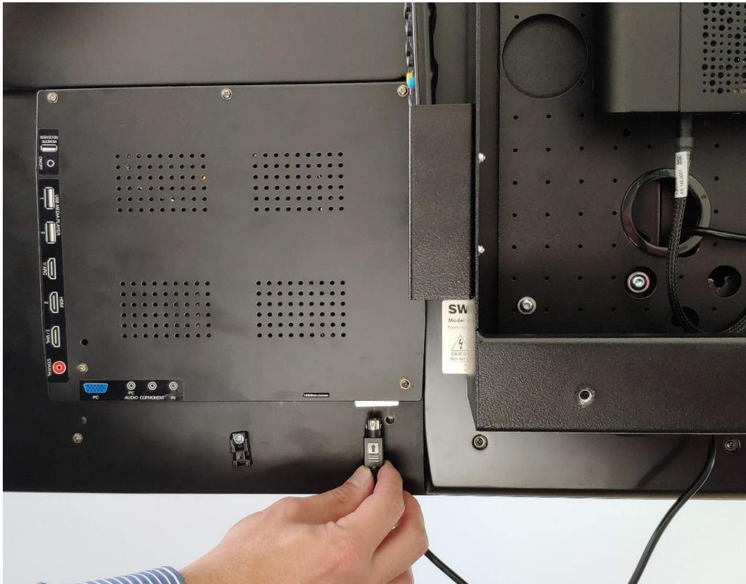
**Schritt 12: HDMI-Kabel mit Medienequipment und Monitor verbinden.**
