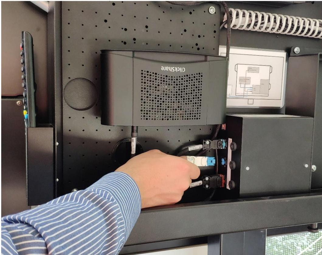
**Schritt 10: DC-Anschlusskabel durch Kabeldurchführung führen.**
