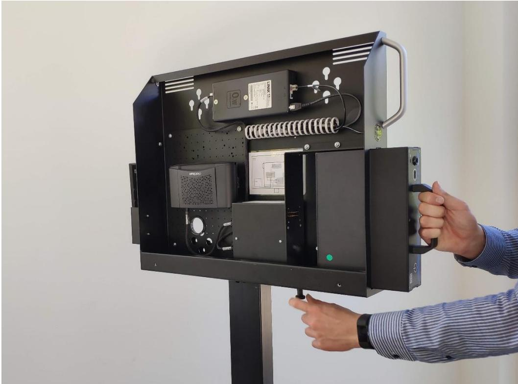
**Schritt 6: Monitor mit den vormontierten Adapterstangen einhängen.**
