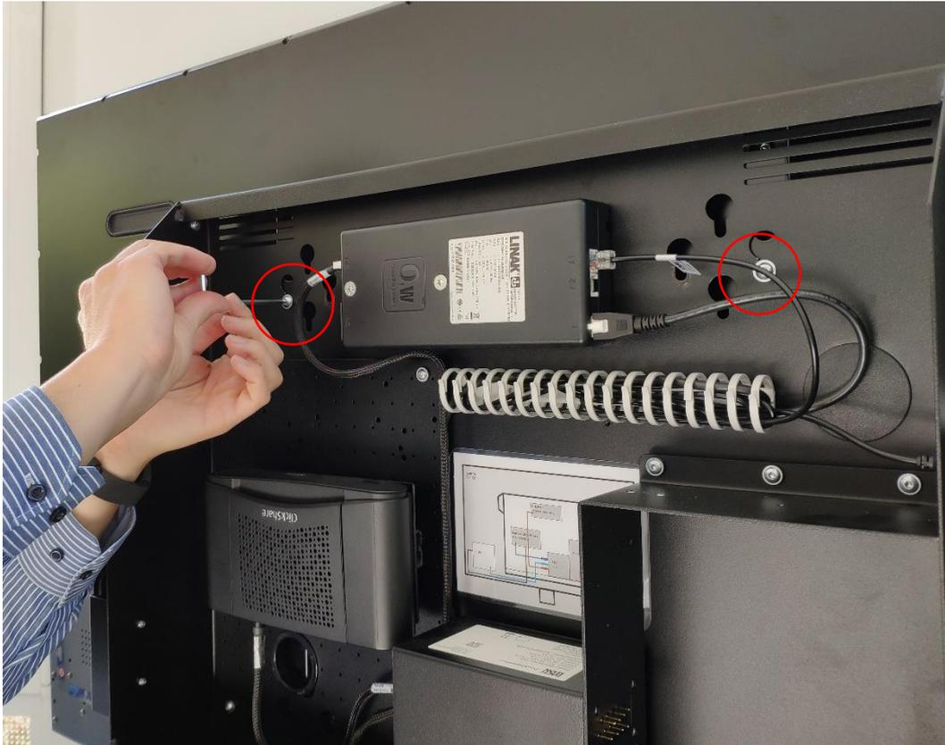
**Schritt 8: Beide Schrauben im unteren Bereich der Monitorbox festziehen.**
