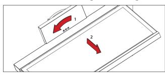
Drehen Sie die montierte Leuchte gegen den Uhrzeigersinn und ziehen sie vom Montagerahmen ab. Anschließend entfernen Sie das Anschlusskabel für das
