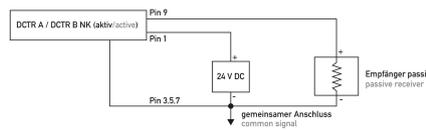
Anschlussschema Pinbelegung zehnpolige Steckbuchse (spannungslos)
