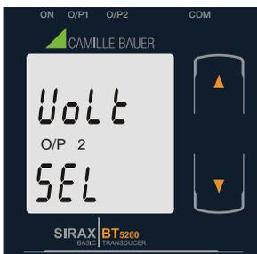
Mit der "➔ AB" Taste gelangen Sie in den "Messausgang 2 Auswahl bearbeiten" Modus und können wechseln zwischen Spannung (Volt) und Strom (CURr).
