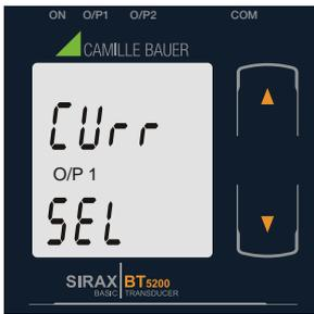
Mit der "➔ AB" Taste gelangen Sie in den "Messausgang 1 Auswahl bearbeiten" Modus und können wechseln zwischen Spannung (Volt) und Strom (CURr).
