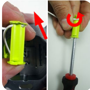
Abb.3-4: Kabel in Spule einführen, aufwickeln
