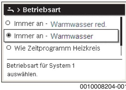
Die Warmwassertemperaturen für die einzelnen Betriebsarten werden vom Installateur eingestellt.
