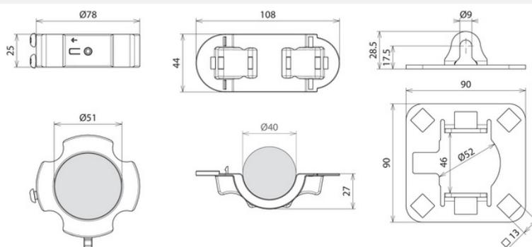
Befestigungsset zur Montage der HVI light plus Leitung an HVI light plus Stützrohren Ø40 mm, bestehend aus Anschlussplatte und Befestigungsring mit NIRO-Spannschelle für den Endverschluss (inkl. vier Kunststoffhalterhalbteilen und zwei Kabelbindern).
