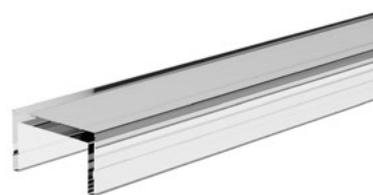
Abdeckung passend für verschiedene Aluminiumprofile. Durch die klare Abdeckung sind zwar die einzelnen LED-Chips der im Profil verbauten LED-Strips zu erkennen, gleichzeitig wird jedoch eine sehr hohe Lichtausbeute erreicht. Technische Daten: Material: UV-beständiges PMMA, Transmissionsgrad: ca. 90%
