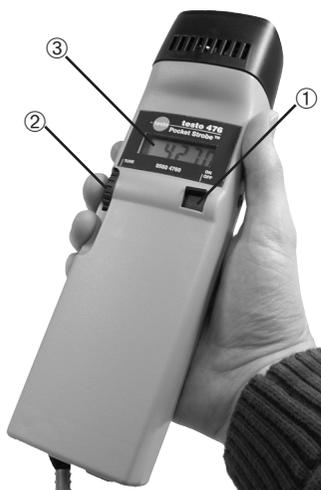
Das **testo 476** kann mit und ohne angestecktem Netzeil betrieben werden. Ist das Gerät mit dem Netzeil verbunden, wird der interne Lithium-Ionen Akku geladen.
