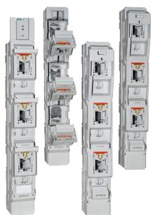
MULTIVERT® NH-Sicherungs-Lastschaltleisten erfüllen sämtliche Funktionen eines NH-Sicherungs-Lasttrennschalters. Die Konstruktion ist für die Direktmontage auf Sammelschienen in dreipoliger Anordnung ausgelegt.
