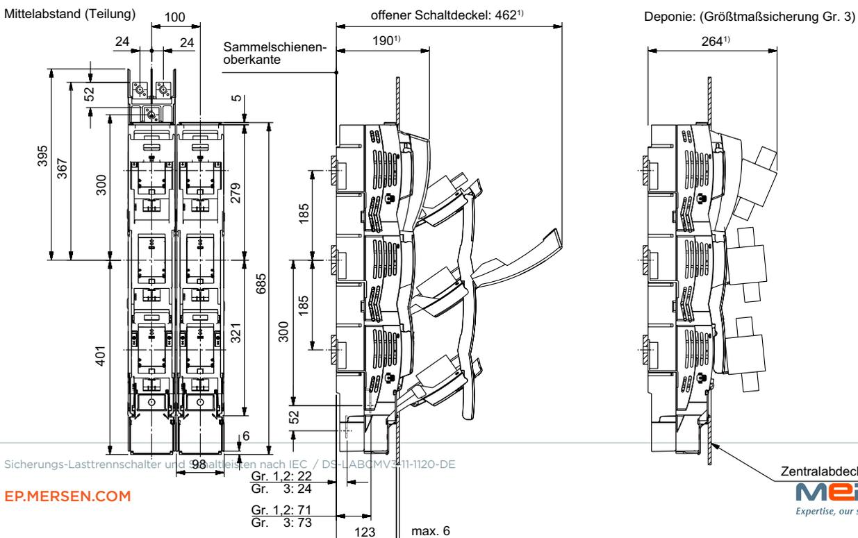
Sicherungs-Lasttrennschalter und Lastschaltleisten nach IEC / DIN-LABCMV 411-1120-DE
