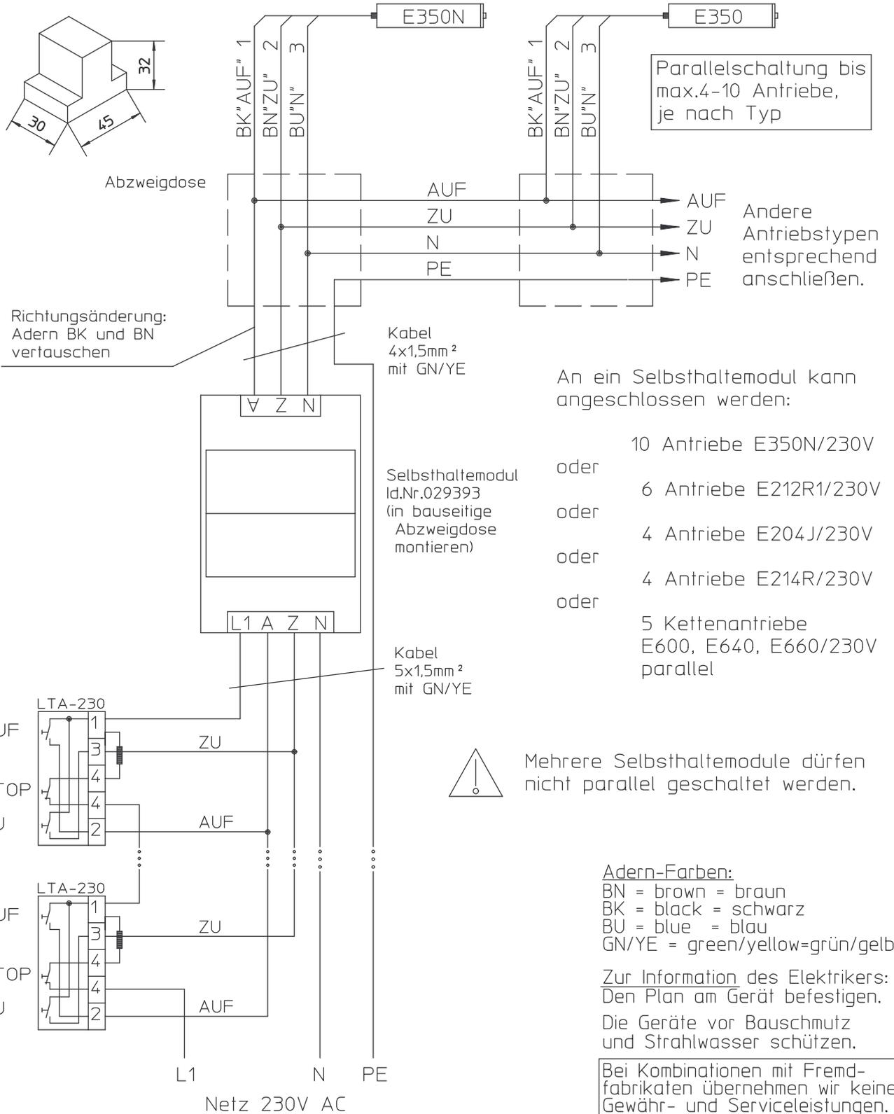
Parallelschaltung bis max.4-10 Antriebe, je nach Typ
