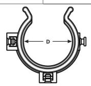
Material: Polyamid 6.6 schlagzäh modifiziert, hitzestabilisiert (PA66HIRHS)
