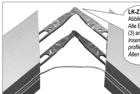
LK-Z 070-060.102.90 Winkelverbinder wie in Abbildung gezeigt in Profil einführen und verbinden. Alle Exzenter und Inbusschrauben wie unter Punkt (3) anziehen.
