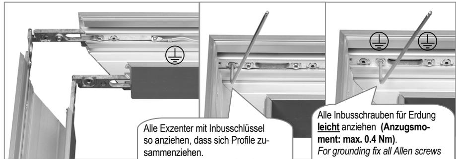
Alle Exzenter mit Inbusschlüssel so anziehen, dass sich Profile zusammenziehen.
