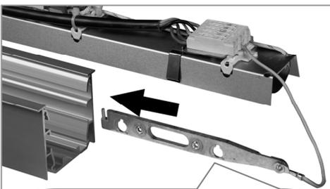
LK-Z 060.111 Erdungsleitung wie gezeigt an PE von Klemme anschließen und Verbinder in Profil einführen. Beide Inbusschrauben für Erdung **leicht** anziehen (Anzugsmoment: max. 0.4 Nm).
