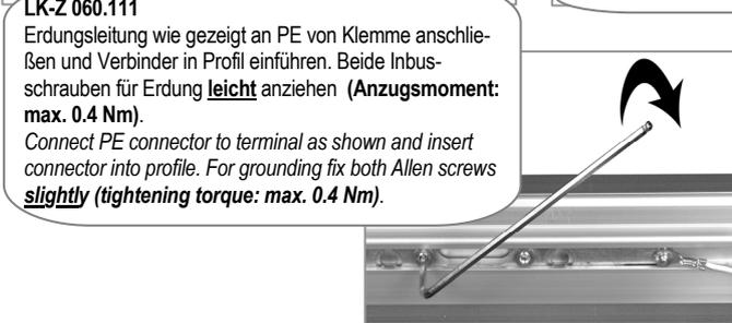
**(3) Lichtkanal 070: Montage Verbinder für Flächenverläufe / Mounting Connectors for Surface Courses**
