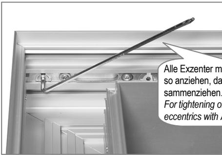
Alle Exzenter mit Inbusschlüssel so anziehen, dass sich Profile zusammenziehen.
